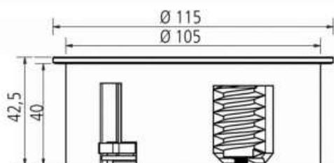
Twist 2 begeistert durch ein erfrischendes, innovatives Design mit hochwertigen Oberflächen. Dank kompakter Bauform und geringer Einbautiefe wird sie platzsparend in Küchenarbeitsplatten oder Schreibtischen integriert. Die Stromleitung wird eng am Gehäuse geführt, so dass die Einbautiefe nur ca. 40 mm beträgt - ein Einbau über Schubladen ist damit problemlos möglich.
