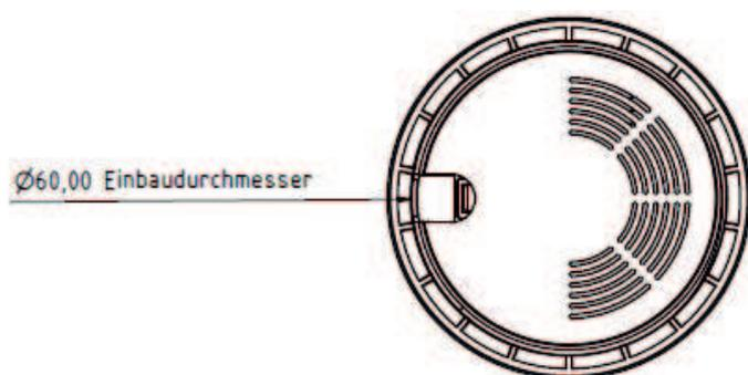
Die Solo Einzelsteckdose bietet eine innovative All-in-One-Lösung, die sowohl Strom als auch einen USB-Charger in einem kompakten Produkt vereint. Mit einer geringen Einbautiefe von 49 mm und einem Einbaudurchmesser von 60 mm ist Solo eine ideale Lösung für enge Platzverhältnisse in der Küche. Das Modell mit dem 20W USB-C Charger ermöglicht ein schnelles und intelligentes Laden von Geräten. Der erweiterte Berührungsschutz mit beweglichem Inlay sorgt zusätzlich für Sicherheit und Design.
