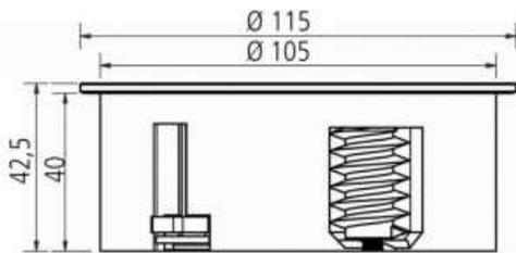
Twist ist eine Steckdoseneinheit für Wohn- und Arbeitsumfeld wie Küche, Büro oder Lounge. Dank kompakter Bauform und geringer Einbautiefe wird sie platzsparend in Küchenarbeitsplatten oder Schreibtische integriert. Die Stromleitung wird eng am Gehäuse geführt, so dass die Einbautiefe nur ca. 40 mm beträgt – ein Einbau über Schubladen ist damit problemlos möglich.
