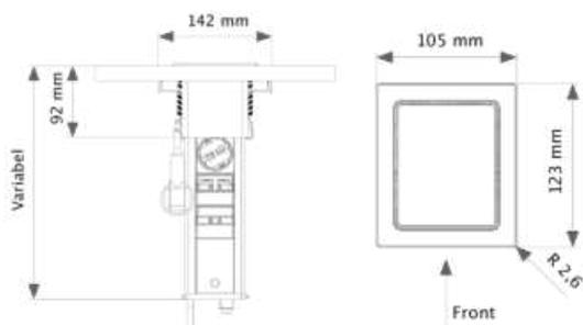
Der Rahmen und der Deckel des EVOLine® Port Push schließt bündig mit der Arbeitsfläche ab und kann auch flächenbündig eingebaut werden. Durch die neue Push-to-Open Technik fährt das Gehäuse eigenständig nach oben und gibt alle Anschlüsse frei. Die Soft-Close Funktion sorgt für sanftes Verschließen und der Kippdeckel funktioniert als Kabeldurchlass.
