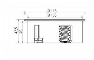
Twist 2 begeistert durch ein erfrischendes, innovatives Design mit hochwertigen Oberflächen. Dank kompakter Bauform und geringer Einbautiefe wird sie platzsparend in Küchenarbeitsplatten oder Schreibtischen integriert. Die Stromleitung wird eng am Gehäuse geführt, so dass die Einbautiefe nur ca. 40 mm beträgt - ein Einbau über Schubladen ist damit problemlos möglich.
