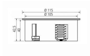
TWIST ist eine Steckdoseneinheit für Wohn- und Arbeitsumfeld wie Küche, Büro oder Lounge. Dank kompakter Bauform und geringer Einbautiefe wird sie platzsparend in Küchenarbeitsplatten oder Schreibtische integriert. Die Stromleitung wird eng am Gehäuse geführt, so dass die Einbautiefe nur ca. 40 mm beträgt – ein Einbau über Schubladen ist damit problemlos möglich.
