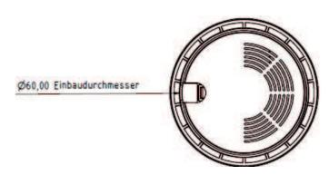
Die Solo Einzelsteckdose bietet eine innovative All-in-One-Lösung, die sowohl Strom als auch einen USB-Charger in einem kompakten Produkt vereint. Mit einer geringen Einbautiefe von 49 mm und einem Einbaudurchmesser von 60 mm ist Solo eine ideale Lösung für enge Platzverhältnisse in der Küche. Das Modell mit dem 20W USB-C Charger ermöglicht ein schnelles und intelligentes Laden von Geräten. Der erweiterte Berührungsschutz mit beweglichem Inlay sorgt zusätzlich für Sicherheit und Design.
