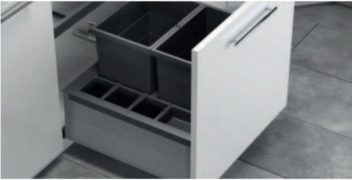
Separato K eignen sich für Schränke mit bestehenden Schubkästen mit einer Stärke zwischen 16 - 19 mm (selbstjustierend). Passend für alle handelsüblichen Zargensysteme. Das System wird auf den Schubkästen gesetzt und mit wenigen Schrauben befestigt. Er besitzt eine ausziehbare Ablage. (NICHT FÜR BLUM LEGRABOX F)
