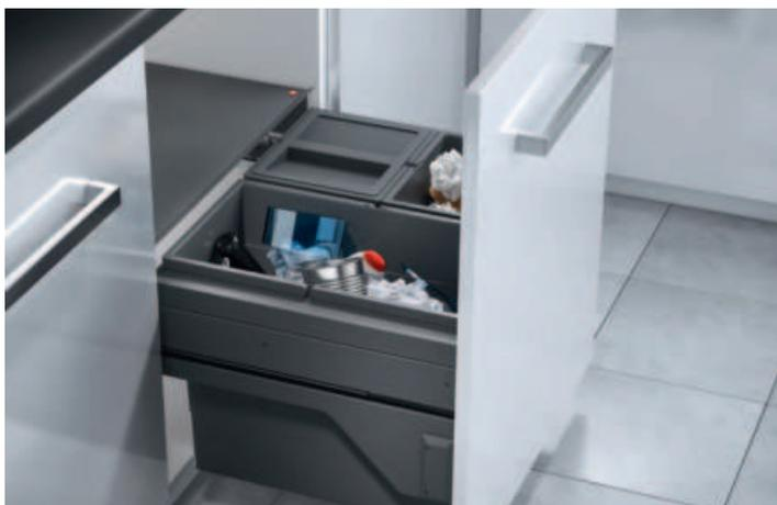
Cargo eignen sich für Schränke mit loser Frontblende bzw. für Korpusse mit einer Stärke zwischen 16 – 19 mm (selbstjustierend). Die Abfallsammler sind einfache Seitenwandmontagen und besitzen ausziehbare Systemdeckel aus Metall, welche als Ablage genutzt werden können. Die Metall- und Kunststoffeile sind anthrazit. Ihre Auszugsschienen sind abgedeckte Selbstzüge mit Überauszügen und Dämpfungen.
