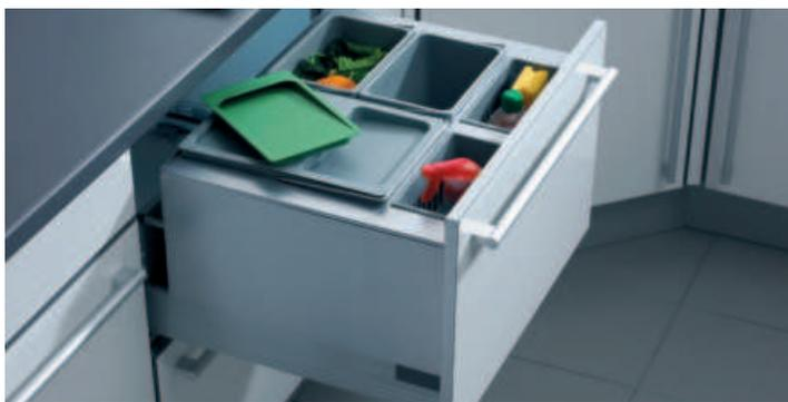
XXL eignen sich für Schränke mit bestehenden Schubkästen mit einer Stärke zwischen 16 - 19 mm (selbstjustierend). Passt für alle handelsüblichen Zargensysteme. Das System wird auf den Schubkästen gesetzt und mit wenigen Schrauben befestigt. Die Metallseitenteile decken die Reling hygienisch ab.
