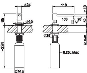
Lochbohrung ab Ø 24 -35 mm
