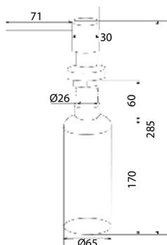
Lochbohrung ab Ø 24 -35 mm
