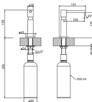
Lochbohrung ab Ø 24 -35 mm
