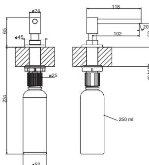
Lochbohrung ab Ø 24 -35 mm
