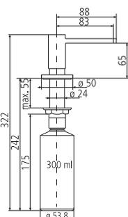
Lochbohrung ab Ø 24 -35 mm
