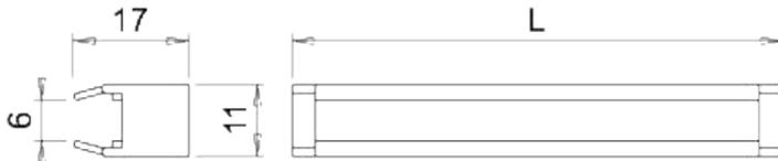
Nubo ist eine Profil mit symmetrischer Lichtverteilung für den umlaufenden Einbau einer 6mm Glasplatte. Netzteil und Steuerung sind nicht im Lieferumfang enthalten.
