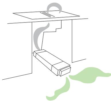
Hoher Leistungsgrad auf kleinstem Platz. Aira Quadro L slimline ermöglicht aufgrund seiner „L-Form“ einen „stehenden Verbau“, der den Luftstrom im 90 Grad Winkel zum Filter ausstößt.
