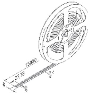
Selbstklebendes LED COB Band mit nur 8 mm Breite. Die Standardlichtfarbe beträgt 2.700°K. Bei Verwendung des Adapterkabels ist die Lichtfarbe 5.000°K.
