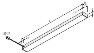
Top-Stick Langfeldleuchten sind hocheffiziente Langfeldleuchten zum Einbau mit verstellbarer Lichtfarbe. Die Standard Lichtfarbe beträgt 2.700°K. Bei Verwendung des beigefügten Adapterkabels ist die Lichtfarbe 5.000°K.
