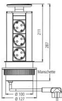
Versenkbare Steckdosenleiste mit drei Schuko Steckdosen. Abdeckung dient im angesteckten und geschlossenen Zustand als Kabeldurchlass.
