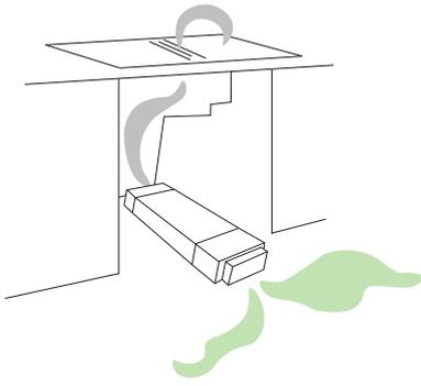
Aira Quadro Plasmafilter sind für Kochfeldabzüge und Downdrafts konzipiert. Auch die Verwendung bei Deckenlüftern ist möglich. Je nach Luftleistung des Dunstabzuges kann der Plasmafilter gewählt werden. Es stehen Filter von 800 bis 1.200m<sup>3</sup> Luftleistung zur Verfügung. Ist im Sockel nicht genug Platz, empfiehlt sich der Quadro L, der stehend hinter dem Schrank montiert werden kann.
