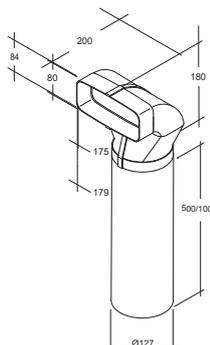
**optimAIRo M Umlenkstück DUO mit Rohr**
